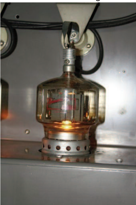
Une des 4 Eimac 4-400A de l'ancien ampli 1KW AM de CJSO : elle fonctionne.
